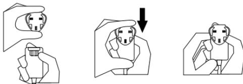
Pour charger le dispositif, attachez la pince du câble de charge à l'appareil, comme indiqué dans l'illustration. Pendant le chargement, vous verrez des clignotements rouges. Une fois que l'appareil est chargé, la lumière rouge s'éteindra.
