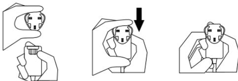
Pripojte priložený USB kábel s A/C adaptérom. Následne pripevnite dobíjajúcu svorku na zariadenie (p. obrázok).
