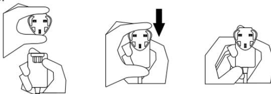
Propojte přiložený USB kabel s A/C adaptérem. Poté připevníte dobíjecí svorku na zařízení (viz. obrázek).
